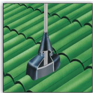
Антиконденсационные аэраторы арт. 57, 58 предназначены для вентиляции ванных комнат, кухонь лабораторий и всех прочих подобных типов помещений. Продукт имеет данное название из-за характеристики своего строения, он не допускает образования конденсации и последующего капания воды вдоль выходных труб, в случае, когда эти трубы взаимодействуют с паром и выходом наружу. Выпускается в двух цветах сером и коричневом.
